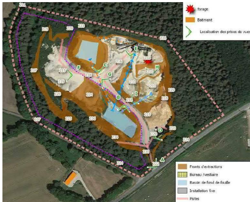
Illustration n°3 : état actuel d'exploitation de la carrière de Botan (source : dossier chapitre 8 p.77)
